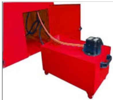
Bomba de refrigeración integrada.
