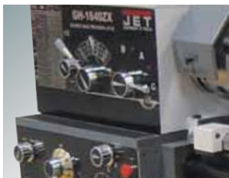
Caja Norton con engranajes templados y rectificadas posibilitan el roscado de numerosos pasos sin cambio de engranajes
