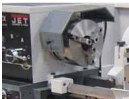
Plato de 250 mm con 3 garras intercambiables y reversibles, protector del plato con pulsador
