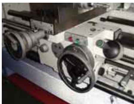
Manejo cómodo del movimiento longitudinal y transversal gracias al Joystick de botón
