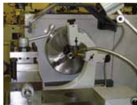
Portaherramientas de 4 posiciones con bloqueo, luneta fija y móvil en el equipo base
