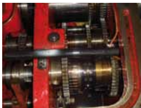
Cabezal con embragues mecánicos que permiten un arranque e inversión de giro muy suaves
