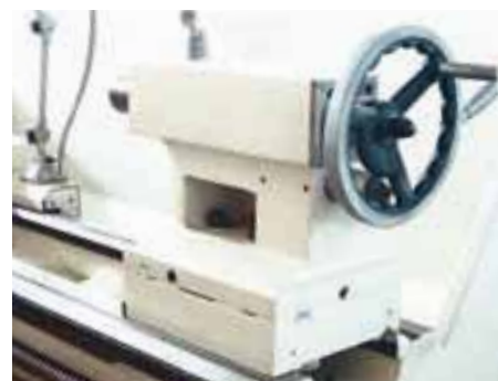
Ajuste del contrapunto para torneado cónico, caña del contrapunto, y volante con escala ajustable
