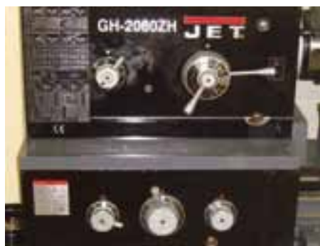
Caja Norton con engranajes templados y rectificados posibilitan el roscado de numerosos pasos sin cambio de engranajes
