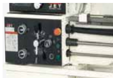
La caja Norton le permite mecanizar gran número de roscas sin cambio de engranajes
