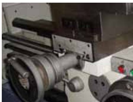
Embrague de avance ajustable y escote desmontable
