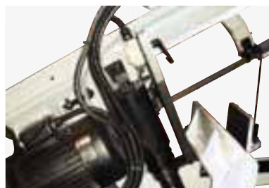
Elevación automática del arco de sierra al terminar el corte
