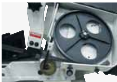
Cepillos de latón integrados para limpiar la hoja de sierra
