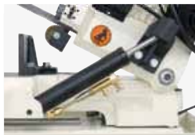
Descenso hidráulico totalmente ajustable
