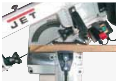
La mordaza puede montarse a ambos lados de la máquina
