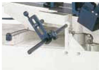
Tope de material ajustable para producción en serie
