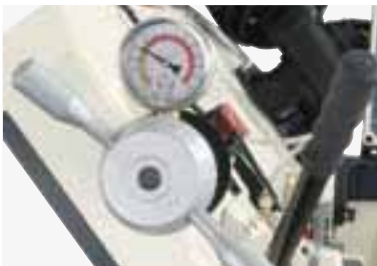
Manómetro de tensión de la hoja de sierra y detector de rotura
