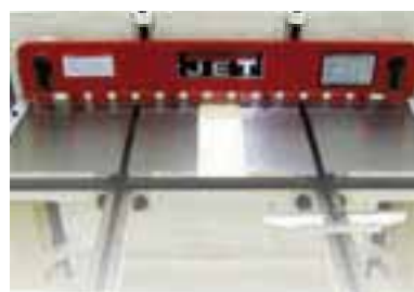
El apoyo y la consola delanteros permiten un posicionado preciso del material
