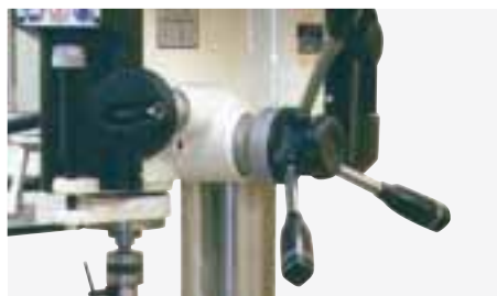
Avance automático (JMD-18PF) 0,12 / 0,18 / 0,25 mm/r
