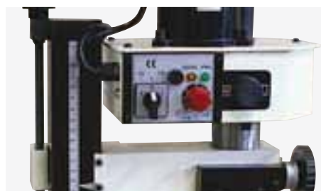
Control de las revoluciones a izqda. y dcha. con caja de engranajes de 2 velocidades
