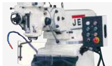
El cabezal gira \pm 90^\circ y se inclina \pm 45^\circ hacia delante y hacia atrás, con una carrera del carnero de 200 a 680 mm
