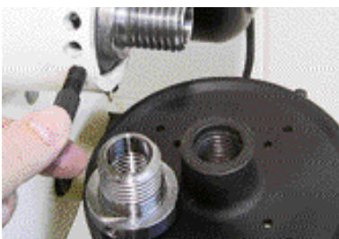
Cabezal con divisiones de 15°, adaptador M33 x 3.5 estándar
