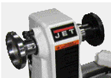
Graduación del cabezal cada 15°
