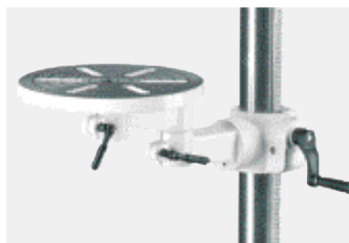
Piñón y cremallera para la regulación de la altura de la mesa e inclinación +/- 90
