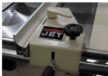
Guía paralela de precisión con leva de bloqueo
