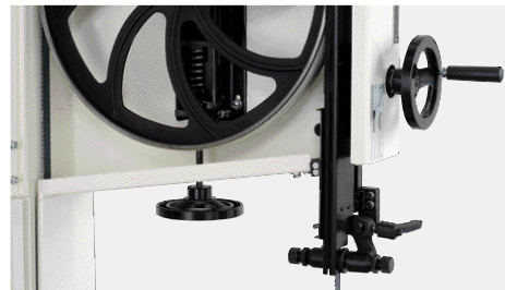
Volantes de fundición contrapesados con recubrimiento de Poliuretano.
