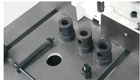
Casquillos reductores con valona de 5/8", 3/4", 13/16", llave para portabrocas y ampliación del husillo
