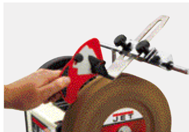
Comprobación del ángulo de lijado con el transportador de ángulos
