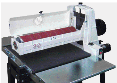
Sistema fácil y rápido para sujetar las bandas de lija
