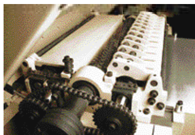
Rodillo de entrada segmentado y cabezal helicoidal
