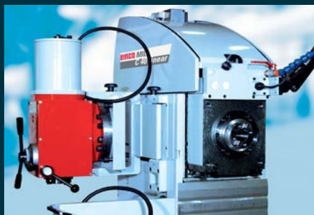
Cambio a fresado horizontal. Cabezal de fresado vertical pivotante. Fresa horizontal DIN 69871 SK 40
