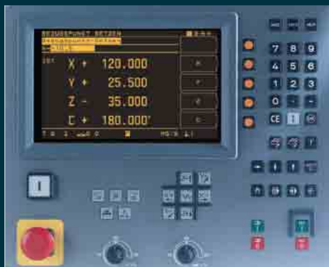
Sistema de control de trayectoria lineal HEIDENHAIN TNC 124 para la ECOMILL FB5
