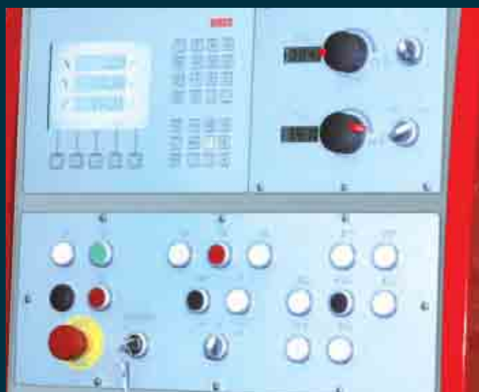
Pantalla de posición de tres ejes de EMCO para la ECOMILL C40
