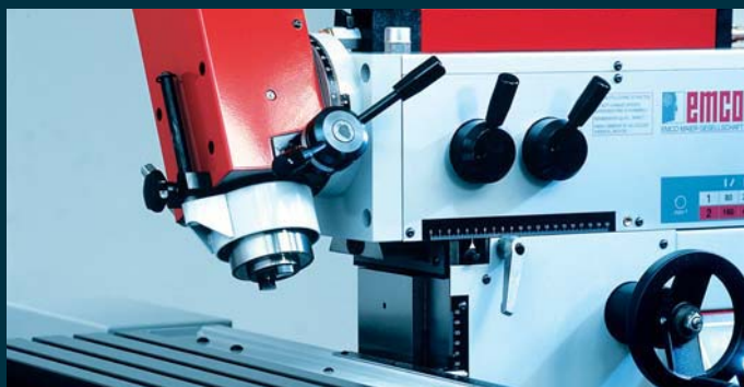
Cabezal fresador vertical. Cabezal fresador vertical con DIN 2080 SK 30 y recorrido de la caña de 45 mm. El cabezal fresador vertical gira +/- 90°.
