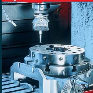
Mecanizado de un disco con el aparato divisor
