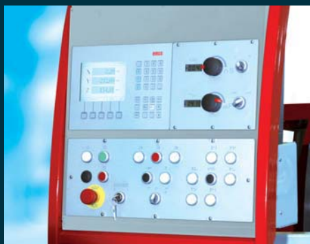
Panel de control. Panel de control digital pivotante con teclado ergonómico de manejo sencillo. Opcional: Pantalla digital EMCO de 3 ejes incluyendo escalas de medida lineales X/Y/Z.
